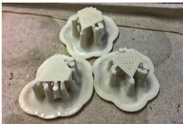
Obr. 1: Neúspěšný tisk materiálu Vitrolite na SLA tiskárně.
