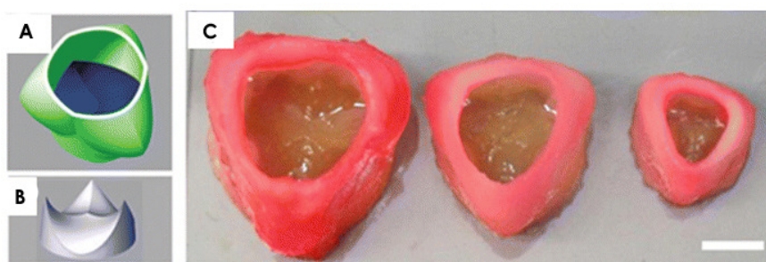
Obr. 3 3D tisk asymetrických srdečních chlopní. 3D modely pro tisk (A, B) a realizované výtisky (C) [9]
