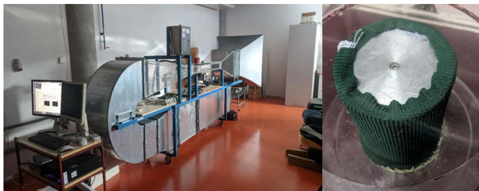
Obrázok 2 Ukážka aerodynamického tunela a testovacia vzorka
